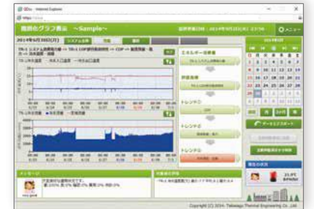
制冷机冷水流量及出入口温度
