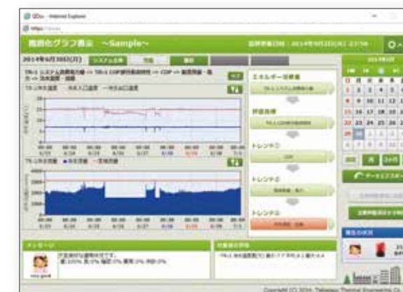
冷凍機の冷水の流量と出入口温度
